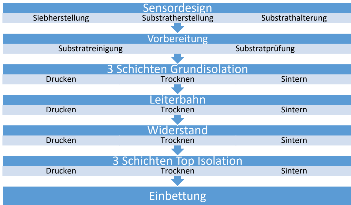
Abbildung 23: Siebdruckprozess in der Übersicht
