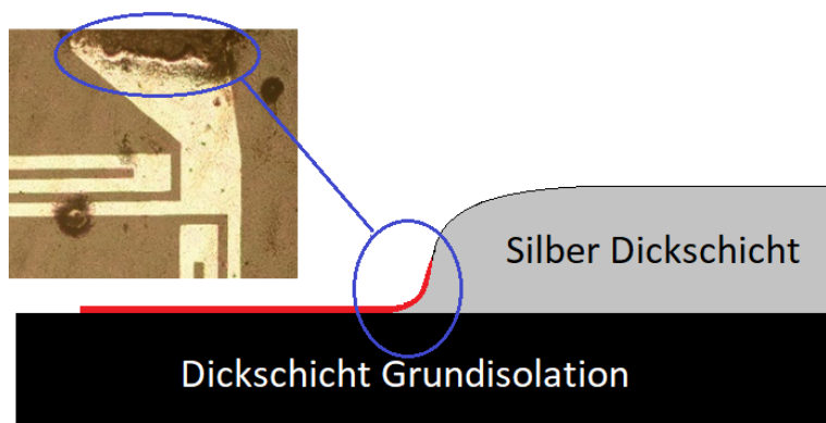
Abbildung 45: Kontaktierung zwischen Dünnschicht und Dickschicht in Mikroskopie und schematisch
