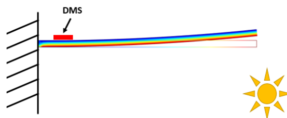
Abbildung 64: Stauchung des DMS durch eine simulierte statische Temperaturdifferenz von 2 °C zwischen der Ober- und Unterseite des Biegebalkens
