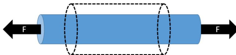
Abbildung 6: Formänderung durch Zugspannung
